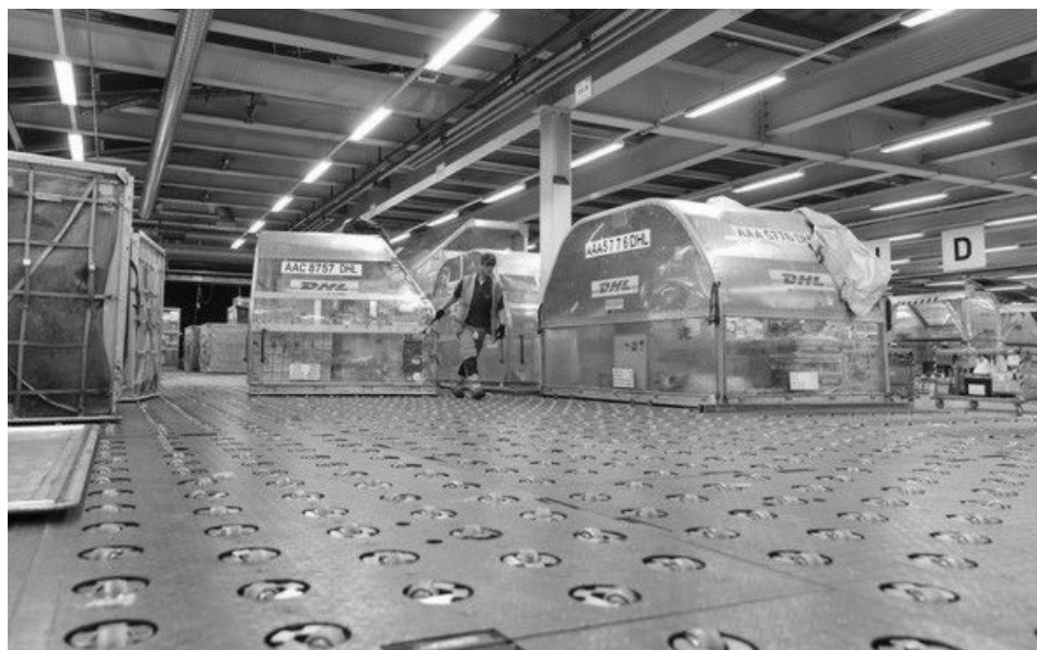
Rysunek 8. Podłoże sortowni DHL wyposażone w specjalne rolki
