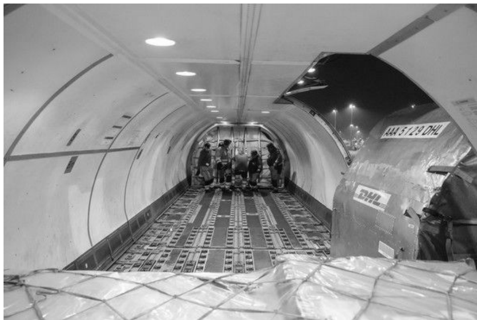
Rysunek 7. Wnętrze samolotu wyposażone w specjalne szyny na podłożu, które ułatwiają przemieszczanie kontenerów
