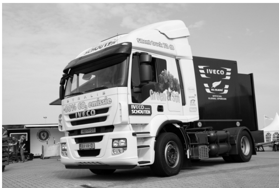
Rysunek 2. Samochód ciężarowy IVECO zasilany skroplonym metanem
