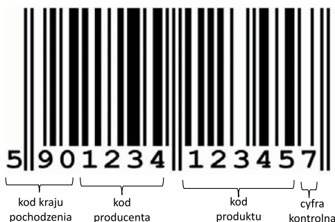
Rysunek 5.3. Elementy kodu kreskowego wg standardu EAN-13
