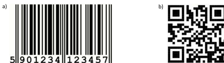
Rysunek 5.2. Przykłady kodów kreskowych: a) kod jednowymiarowy, b) kod dwuwymiarowy QR
