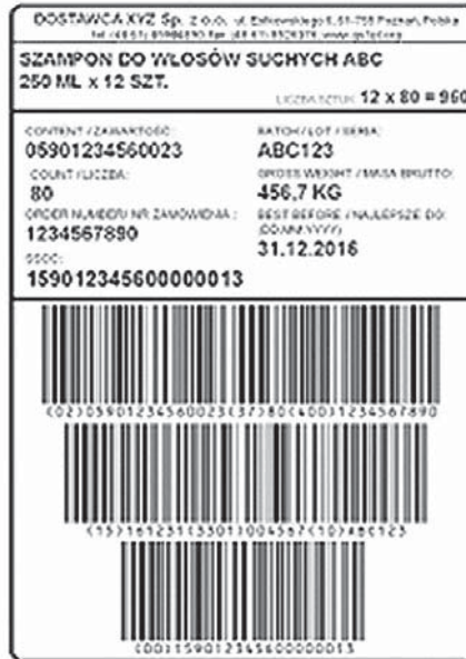
Rysunek 5.5. Przykład etykiety logistycznej zgodnej ze standardem GS1
