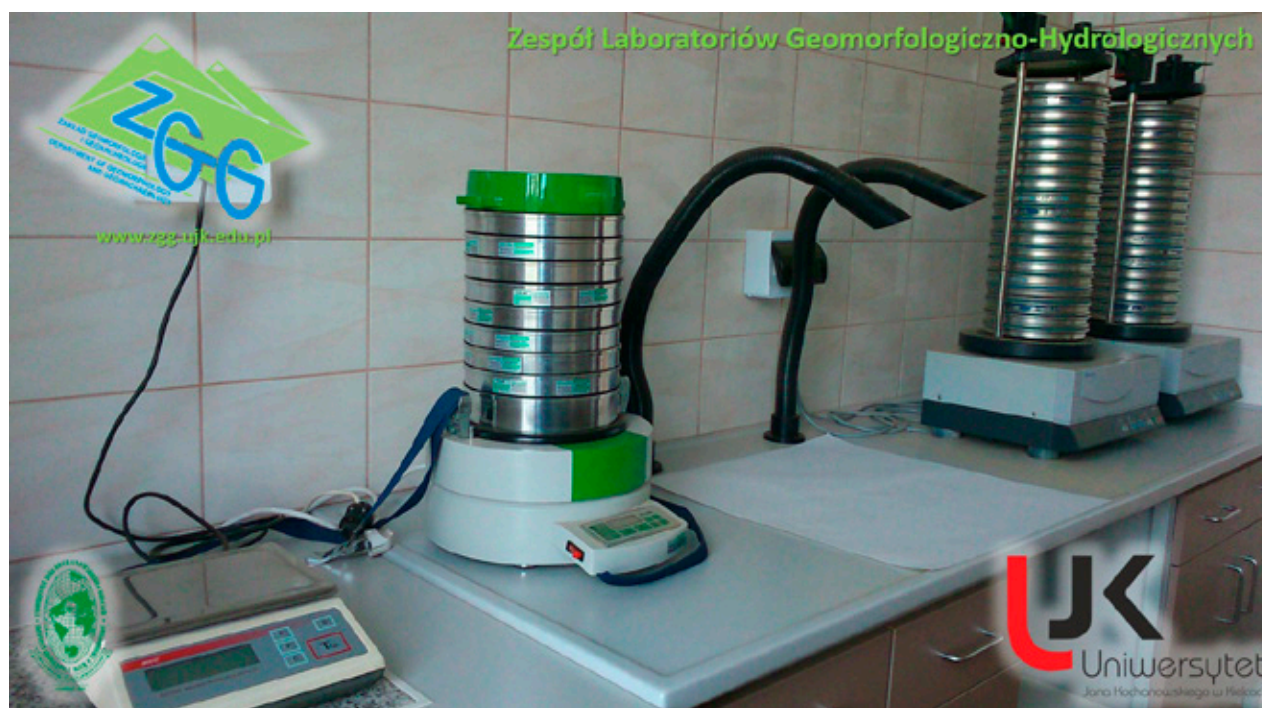
Fot. 2. Wyposażenie Zespołu Laboratoriów Geomorfologiczno-Hydrologicznych w Instytucie Geografii i Nauk o Środowisku Uniwersytetu Jana Kochanowskiego w Kielcach. Na zdjęciu (od lewej) widoczny zestaw sit i przesiewacze firmy „Multiserw-Morek” LpzE-2e oraz „Retsch – Rahmen” (z prawej; fot. P. Przepióra)
