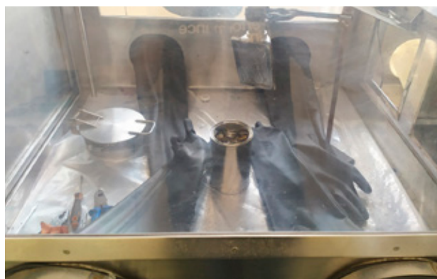
Fot. 10. Wnętrze komory rękawicowej do demontażu izotopowych czujek dymu. Na środku widoczna jest stalowa puszk ze zdemontowanymi źródłami
