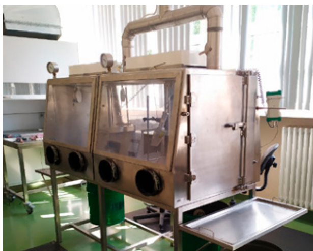
Fot. 9. Komora rękawicowa używana do demontażu izotopowych czujek dymu
