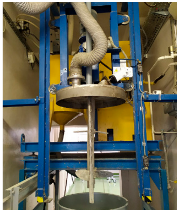
Fot. 7. Mieszadło wraz z zintegrowanym systemem dozowania cementu oraz zażęzonych ciekłych odpadów Photo 7. Agitator with integrated cement and concentrated liquid waste dosing system
