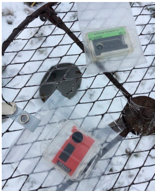
Fot 5. Detektory TLD służące do pomiaru dawki pochłoniętej od tła promieniowania jonizującego
