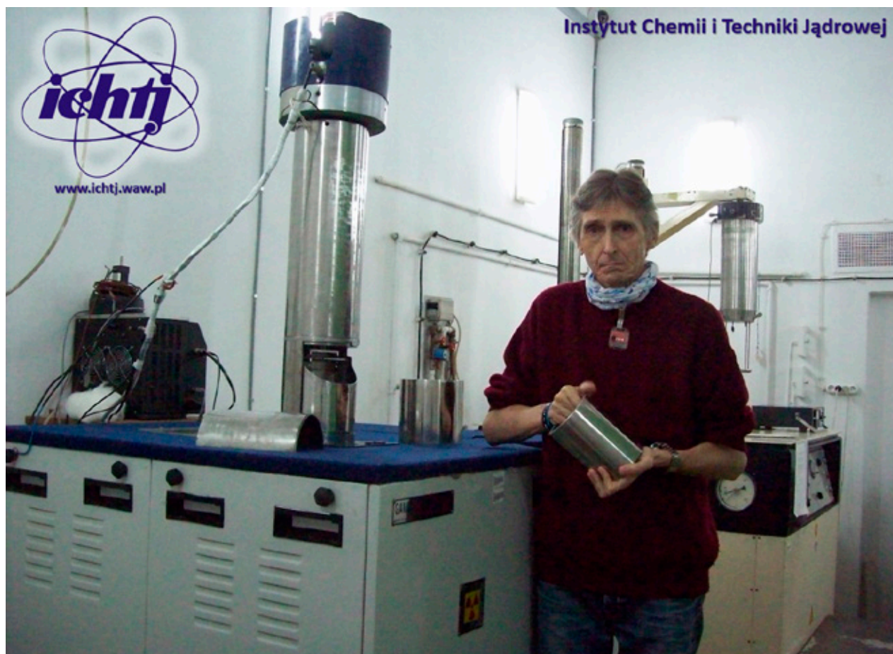
Fot. 1. Laboracyjne źródła promieniowania gamma w Instytucie Chemii i Techniki Jądrowej w Warszawie. Na pierwszym planie GC 5000 (moc dawki 2,20 kGy/h, listopad 2020). Na drugim planie Isledovatel (moc dawki 0,21 kGy/h, listopad 2020; fot. W. Głuszewski)
