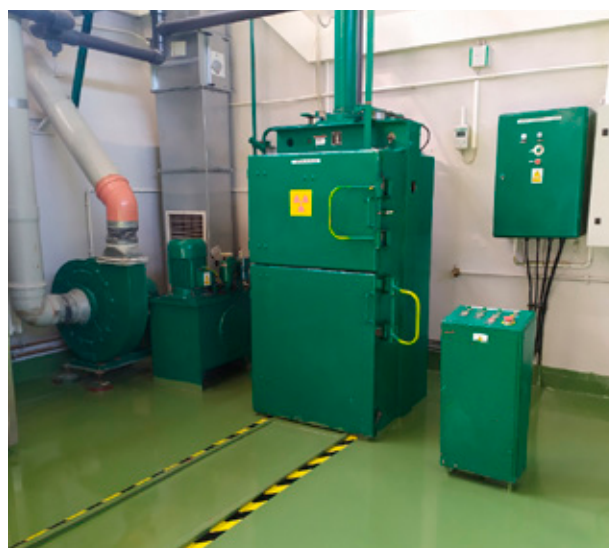
Fot. 8. Prasa hydrauliczna wykorzystywana do prasowania odpadów promieniotwórczych Photo 8. A hydraulic press used for radioactive waste compaction
